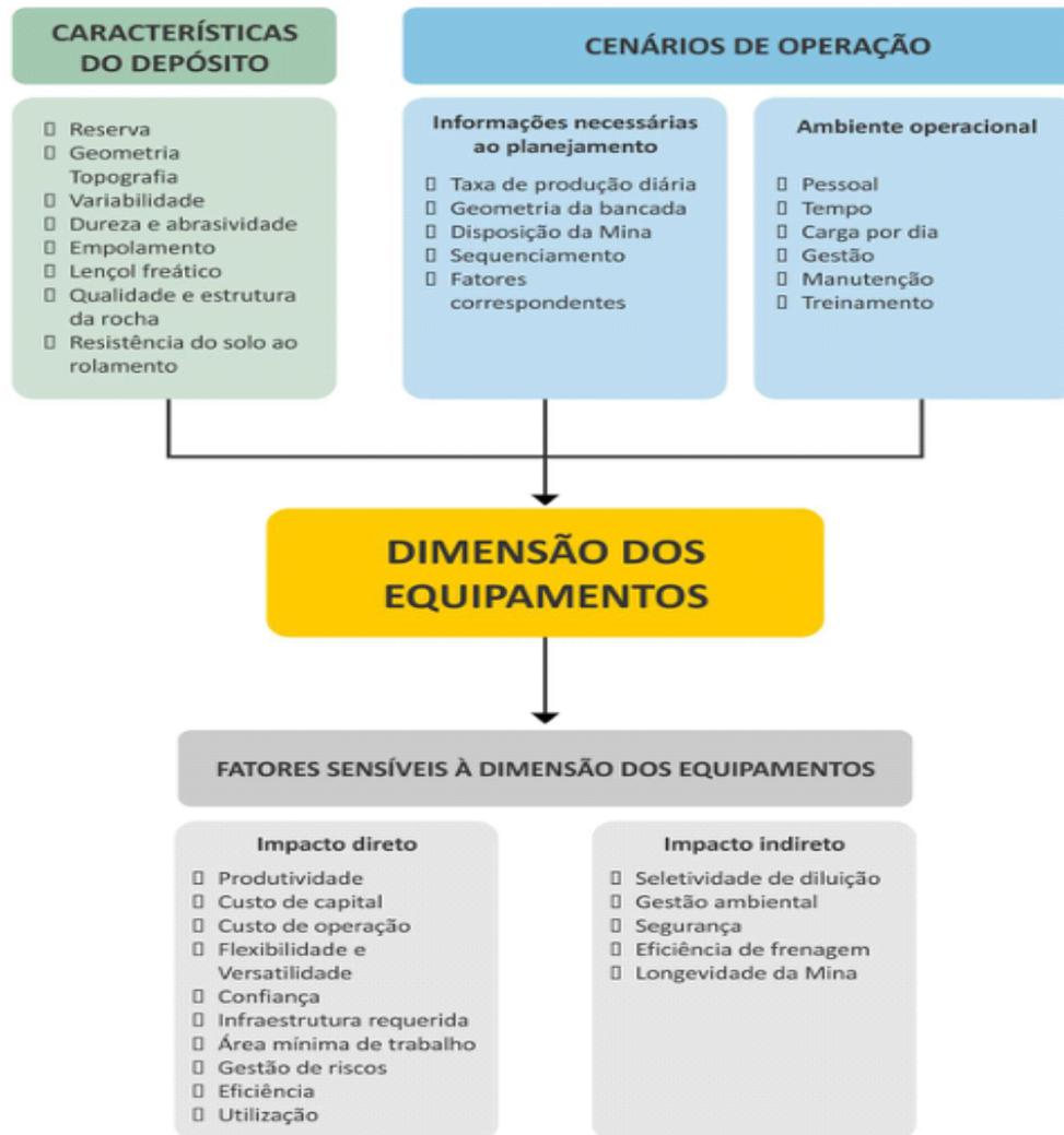
**Figura 7 -** Selecção de equipamentos e factores sensíveis ao dimensionamento dos equipamentos (BOZORGEBRAHIMI, HALL and BLACKWELL, 2003)
